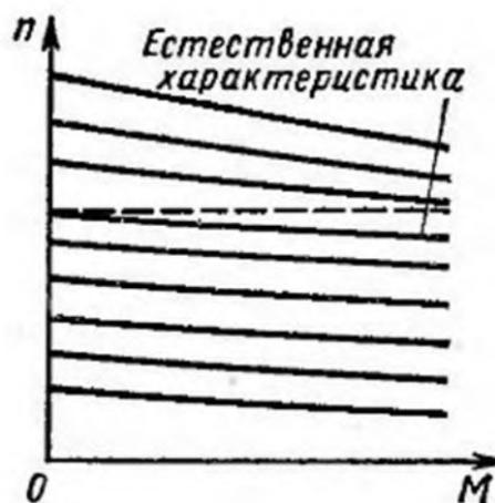
Рис. 3. Механические характеристики системы генератор - двигатель постоянного тока
