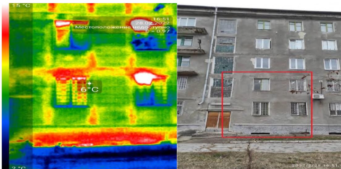
Рис. 1. Терммограмма части фасада здания корпуса «Б»
